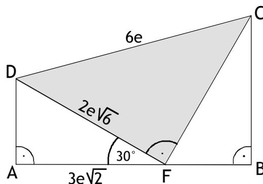
Mit  $\varepsilon = 180^\circ - 90^\circ - 30^\circ = 60^\circ$  kann nun im rechtwinkligen Dreieck FBC die Strecke  $\overline{BC}$  berechnet werden. Es gilt:
